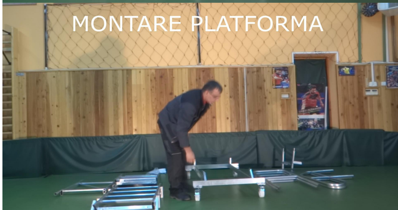
PAS 1 (se foloseste PUNGA 1): Se monteaza traversa spate si scara la platforma
